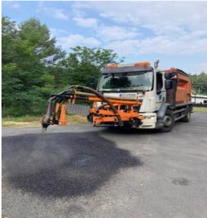
Remonter STRASSMAYR zabudowany na podwoziu samochodu ciężarowego marki DAF
